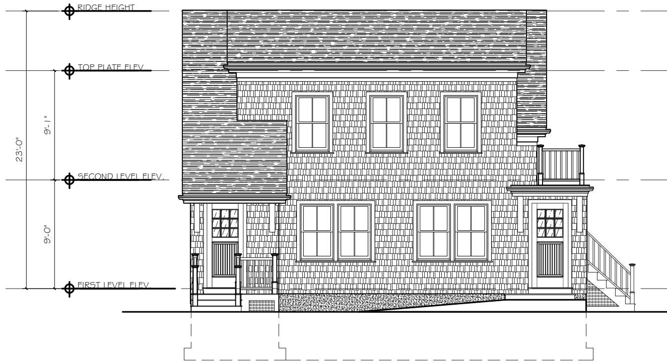
1 FRONT ELEVATION SCALE: 1/8" = 1'-0"
