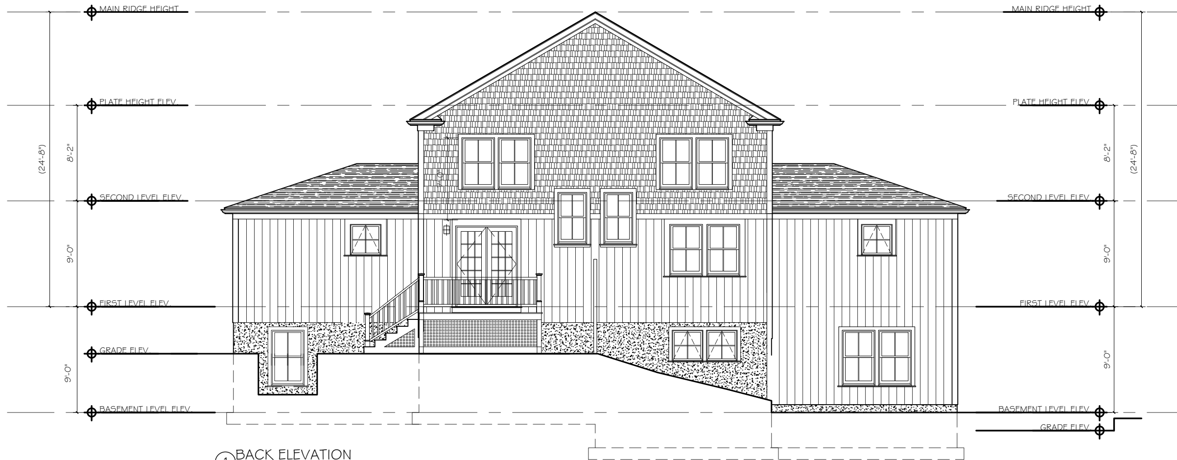
1 BACK ELEVATION SCALE: 1/8" = 1'-0"
