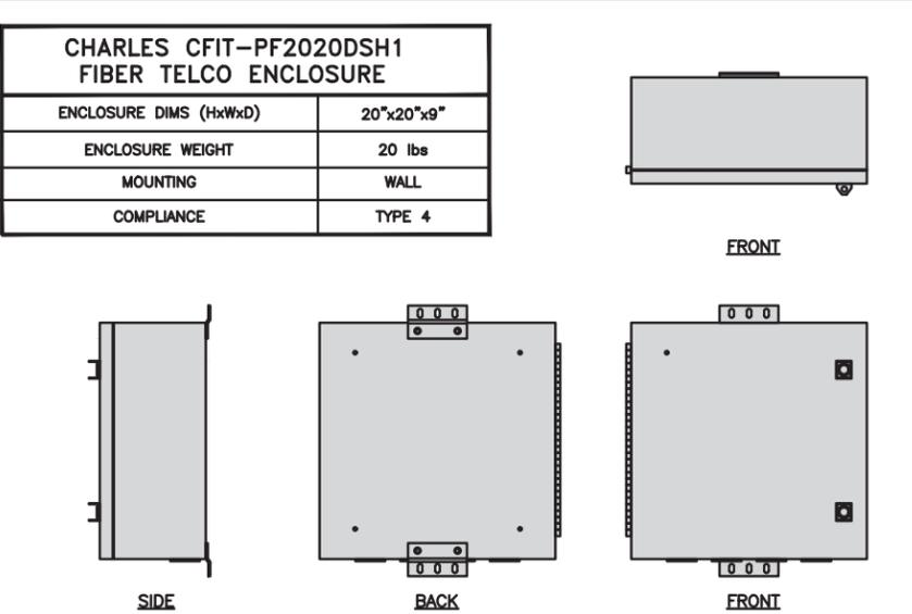
**FIBER TELCO ENCLOSURE DETAIL** NO SCALE 6
