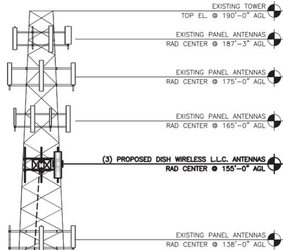
(1) PROPOSED DISH WIRELESS L.L.C. HYBRID CABLE ON EXISTING WAVEGUIDE LADDER
